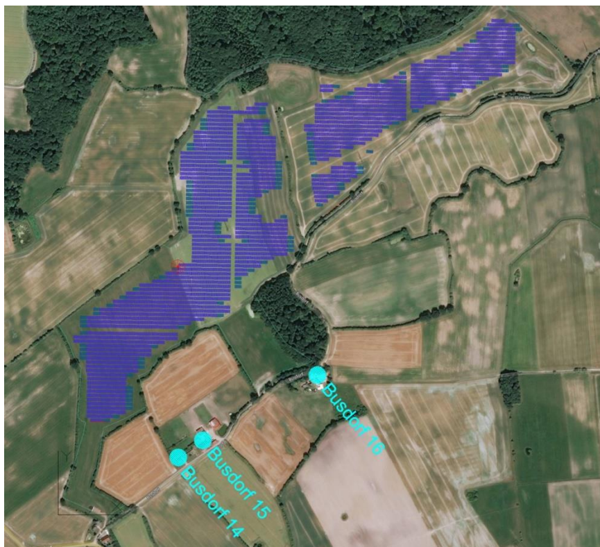
Abbildung 12: Blickpunkte (cyanfarbene Kreise) für Wohngebäude im Reflexionsbereich der PV-Anlage
